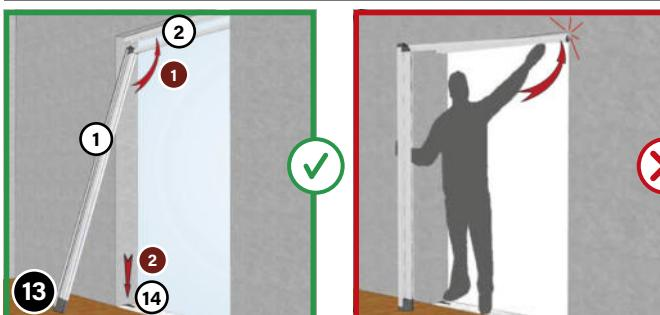
Bringen Sie den Kasten ① in Position, indem Sie ihn mitsamt der Z-Schiene ③ etwas schräg in die U-Führungsschiene ② „einfädeln“ (erst oben ①, dann unten ②).
