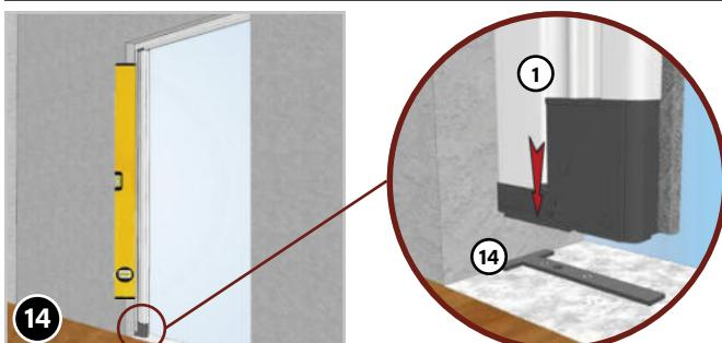
Im unteren Bereich den Kasten ① auf die Kastenhalterung ⑭ aufstecken. Dadurch wird der Kasten an seiner Position fixiert.
