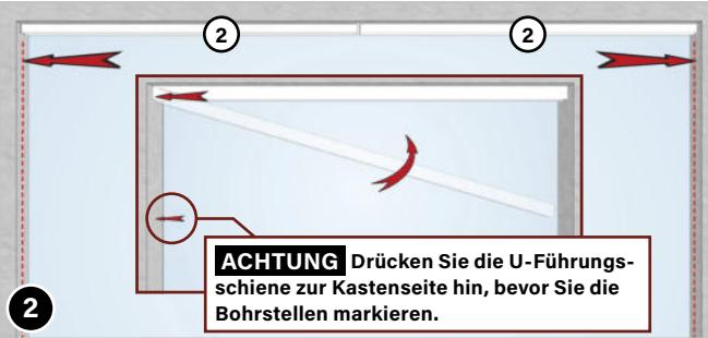
Halten Sie die U-Führungsschienen (2) an die Stelle der Decke/des Sturzes, an welcher das Rollo später verlaufen soll. Drücken Sie es gegen die Wand auf der Kastenseite – dadurch entsteht zwischen den U-Führungsschienen ein kleiner Spalt. Dort wird gegen Ende der Montage dann noch die Führungshauben (16) aufgesteckt und dafür ist minimal Platz notwendig.
