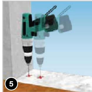
Markieren Sie im Boden die Bohrstellen und bohren Sie die Löcher mit einem Bohrer Ø 6 mm ( **TIPP** bei Holz reicht es mit einem kleinen Bohrer vorzubohren).
