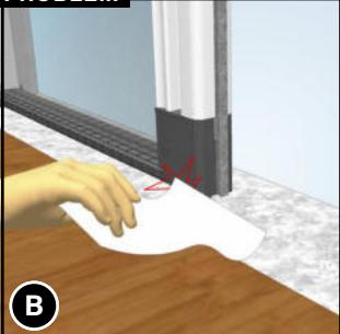
Das Rollo läuft zu stramm. Nehmen Sie zum Test ein Papierblatt zur Hand. Sollte sich dieses im unteren Bereich nicht mehr unter die geöffnete Griffsschiene schieben lassen, so müssen Sie die Z-Schiene (3) regulieren.
