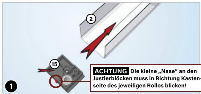
Schieben Sie die Justierblöcke (15) in die U-Führungsschienen (2) ein. Je nach Breite des Rollos müssen 2-3 Justierblöcke eingeschoben werden. Diese schieben Sie direkt über die bereits vorhandenen Bohrungen in der U-Führungsschiene.
