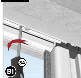
Lockern Sie dazu zuerst die Befestigungsschrauben (27) (28) in den Justierblöcken (15) und dann die großen Gewindeschrauben. Montieren Sie die Z-Schiene so, dass sich diese parallel zum Boden befindet.
