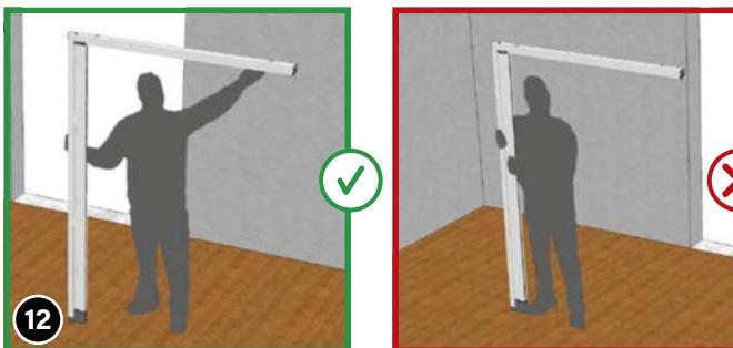
**ACHTUNG** Die aufgesteckte Z-Schiene ③ am Kasten ① darf während der restlichen Montage nicht losgelassen werden, bis diese vollständig an der U-Führungsschiene ② angeschraubt wurde! Möglichst waagerecht halten!
