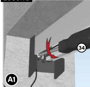
Rollen Sie das Rollo zuerst auf (Griffsschiene muss sich am Kasten befinden). Lockern Sie dann die Schraube am Seilschuh (Teil am Ende der Z-Schiene (3)) mit dem Schlüssel T15 (34) ein wenig.
