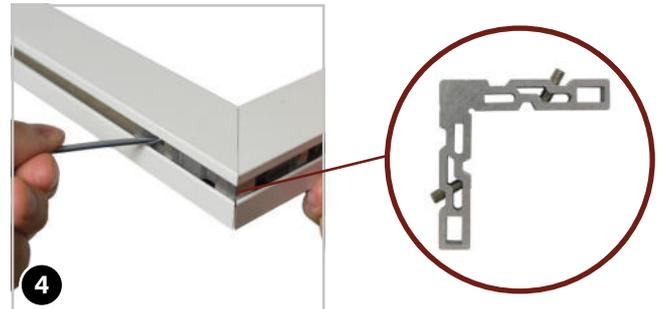
Nun einen Eckverbinder 2 für Montagerahmen in ein langes und ein kurzes Montagerahmen-Profil 30 einschieben. Die Profile an der Ecke so ausrichten, dass diese sauber zusammenstoßen. Danach den Eckverbinder mit dem beiliegenden Sechskantschlüssel 9 in beiden Montagerahmen-Profilen anschrauben. So auch mit den restlichen Profilen vorgehen, bis Sie einen an den Ecken geschlossenen Montagerahmen erhalten.
