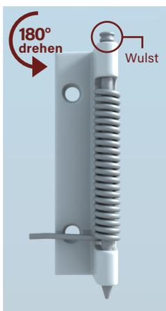
Der Stift im Türschließer muss mit der Wulst nach oben sein. Ggf. muss der Türschließer gedreht und der Stift anders rum in diesen eingeschoben werden.
