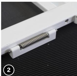
Überprüfen Sie nun, wo sich das überstehende Ende der Metallfeder am Schwingtür-Rahmen befindet. Genau dort machen Sie als nächstes seitlich im Rahmen eine Bohrung von ca. Ø 3mm mit einem Metall-Bohrer.
