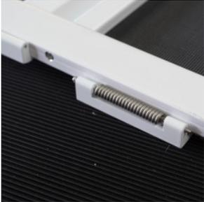
2) Überprüfen Sie nun, wo sich das überstehende Ende der Metallfeder am Schwingtür-Rahmen befindet. Genau dort machen Sie als nächstes seitlich im Rahmen eine Bohrung von ca. Ø 3mm mit einem Metall-Bohrer.
