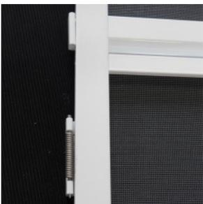
3) Danach nehmen Sie die Rahmentür ab und schrauben zunächst nur den Türschließer mit den drei beiliegenden Schrauben 3x20 am Türrahmen an (ggf. vorbohren). Anschließend können Sie die Rahmentüre wieder einhängen und das Ende der Feder im Türschließer in die Bohrung einstecken. Fertig!
