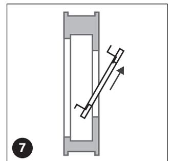
**TIPP** Schieben Sie die Winkelaschen nicht bis zum äußersten Ende der Profilkante, sondern nur bis zur Innenkante! Nun Winkelaschen für oben (längerer Schenkel) (1) und unten (kürzerer Schenkel) (2) am Rahmen anbringen.
