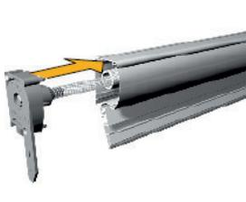
Schieben Sie das Kopfteil mit Feder (1 + 11) in die Welle des Netzes im Rollokasten, bis die Feder noch ca. 10 cm raussteht.
