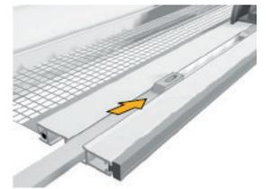
Schieben Sie die Kunststoffstangen auf beiden Seiten des Griffes (9), mit dem Einsteller (91) voraus, ebenfalls in die vordere Nut der Griffschiene ein.
