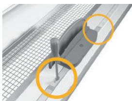
Schrauben Sie die beiden Kunststoffstangen am Griff (9) vorläufig leicht an (schwarze Schrauben sind im Griff-Zubehörpäckchen enthalten).
