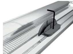
Den Druckgriff (9) in der Mitte der Griffschiene mit der Madenschraube (7) unter Zuhilfenahme des Sechskantschlüssels (50) mittig (!) Befestigen.
