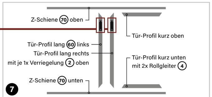
Profile zur Orientierung vor dem weiteren Zusammenbau auf eine weiche Unterlage legen. Überprüfen Sie nun die bisherige Montage.
