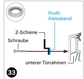
Die Z-Schiene (70) mit dem bereits angebrachten Profil-Klebeband (40) ca. 20 mm entfernt von der Oberkante des unteren Türrahmens ankleben.
