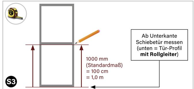
Position der Sprosse (90) ermitteln; dazu mit einem Maßband ab Unterkante des Schiebetür-Rahmens bis Unterkante Sprosse messen. Dann die Stelle mit einem Stift auf beiden Seiten der Tür-Profile (60) markieren.
