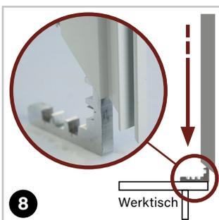
**WICHTIG** Eckverbinder (1) vor der Montage mit etwas Mehrzweckfett/Schmiermittel einfetten, damit diese leichter in die Profile gleiten können! Eckverbinder ganz gerade in die Profile (60) einschieben und
