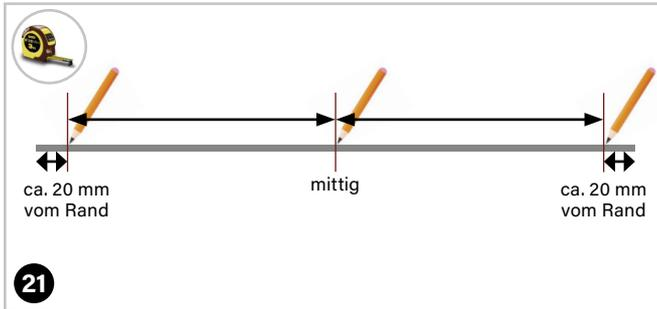
Zunächst die Bohrlöcher an den kurzen Schenkeln der Z-Schienen (70) ausmessen und mit einem Stift markieren – je nach Länge 3-5 Bohrlöcher.
