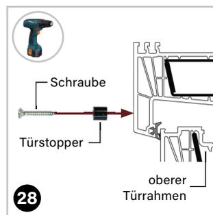
Dann mit Bohrer die Löcher Ø 2-2,5 mm bohren und je einen Türstopper (5) mit einer der beiliegenden Schrauben 4x25 pro Seite anschrauben.
