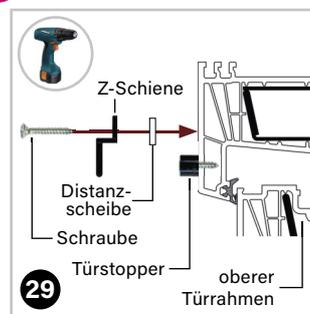
Dann erst die obere Z-Schiene (70) mit den beiliegenden Schrauben 4x20 und Distanzscheiben (7) am Türrahmen anschrauben.
