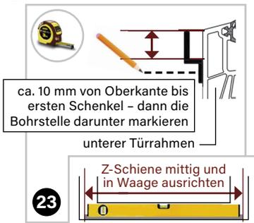
Z-Schiene (70) 10 mm unterhalb der Kante des unteren Türrahmens (nicht Türflügel!) anhalten. Dann vermitteln (rechts und links in gleichem Maß überstehend) und dann Bohrlöcher markieren.
