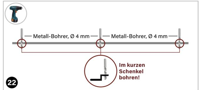
Anschließend die Löcher beider Z-Schienen (70) (jeweils im kurzen Schenkel) bohren. **TIPP** Die Bohrstellen dürfen auch etwas verschoben werden, falls Sie an einer bestimmten Stelle am Türrahmen nicht anschrauben können.
