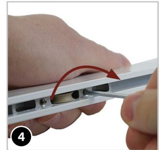
Rollgleiter (4) mittels Sechskantschlüssel (50) im äußeren Tür-Profil-Bereich (ca. 100 mm von Kante) rechts und links anschrauben.
