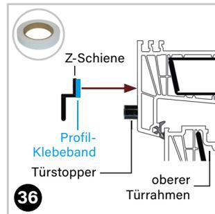
Die Z-Schiene (70) mit dem bereits angebrachten Profil-Klebeband (40) an den Türrahmen ankleben.
