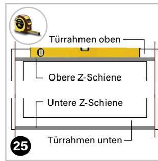
Die Schiebetür auf untere Z-Schiene (70) aufstellen und obere Z-Schiene am Türrahmen anlegen. Die obere Z-Schiene so ausrichten, dass die Schiebetüre mit Durchmesser Ø 2-2,5 mm im Türrahmen vorbohren.
