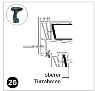
Anschließend die Löcher mit Durchmesser Ø 2-2,5 mm im Türrahmen vorbohren. **ACHTUNG Die obere Z-Schiene (70) noch nicht anschrauben!**
