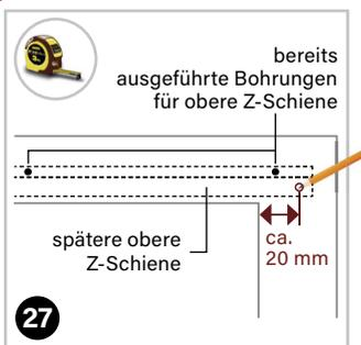
Je ein Türstopper (5) pro Seite ca. 20 mm von der Türrahmen-Innenkante entfernt anbringen; zunächst Bohrstellen markieren.
