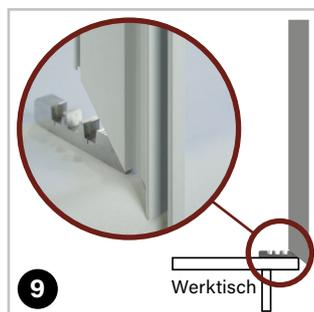
an Werk Tisch-Kante anlegen. Kurzes Tür-Profil bis Anschlag nach unten ganz gerade auf den Eckverbinder aufschieben - auf anderer Seite zweiten Eckverbinder aufschieben.
