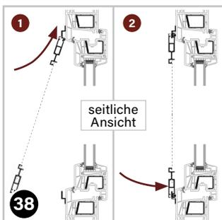
Die Schiebetür erst oben (1), dann unten (2) in die Z-Schienen (70) einfädeln.
