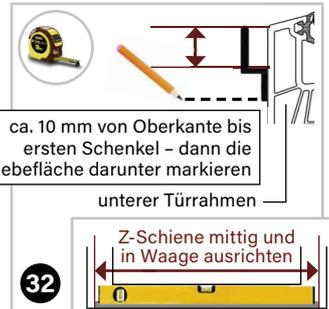
Z-Schiene (70) 10 mm unterhalb der Kante des unteren Türrahmens (**nicht Türflügel!**) anhalten. Dann vermitteln (rechts und links in gleichem Maß überstehend) und dann eine Klebelinie markieren.
