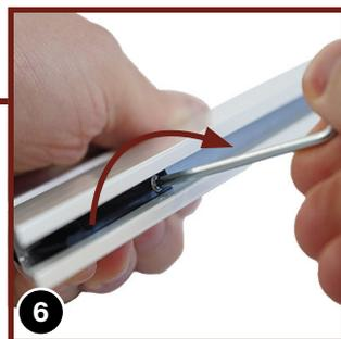
Verriegelung (2) mit Sechskantschlüssel am äußeren Ende der langen Tür-Profile (60) anschrauben.
