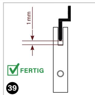
Die beiden Verriegelungen (2) nach oben schieben (**ca. 1 mm Abstand zu Z-Schiene (70) einhalten!**), danach mit Sechskantschlüssel (50) die Gewindegewinde festziehen.
