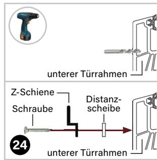
Z-Schiene (70) abnehmen und Löcher Ø 2-2,5 mm bei Markierungen im Türrahmen vorbohren. **ACHTUNG Bohrungen am Türrahmen vornehmen - nicht am Türflügel.** Z-Schiene an Türrahmen durch Distanzscheiben (7) mit Schrauben 4x20 anschrauben (Distanzscheibe zwischen Z-Schiene und Türrahmen anbringen).
