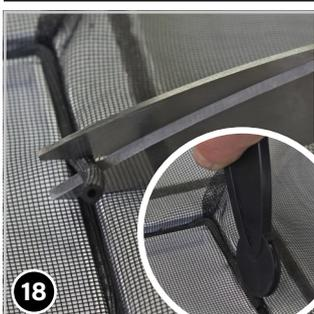
Gummikeder 9 am Ende ca. 10 mm länger lassen; dann mit Messer oder Schere abschneiden. Anschließend das Ende in Nut stecken und Wulst mit Kedereindrücker 6 eindrücken.
