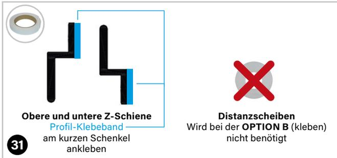
Profil-Klebeband (40) an den Z-Schienen (70) am kurzen Schenkel ankleben.
