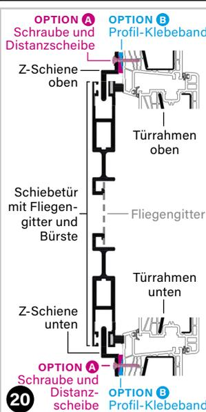
Beide Z-Schienen 70 haben einen kurzen und langen Schenkel:
