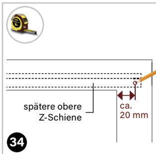
Markieren Sie für die Türstopper (5) zunächst die Klebestellen wie im Bild oben beschrieben.
