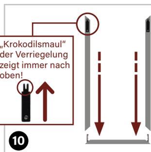
Beide Tür-Profile lang (60) mit Tür-Profil kurz mit Rollgleiter (4) verbinden - dabei auf die richtige Ausrichtung der Bürste achten! **ACHTUNG** Einmal zusammengesteckt lassen sich die Profile nicht mehr lösen!
