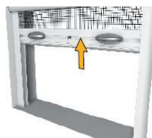
● Schieben Sie das Rollo herunter bis es im PullDown-Sockel (75) einrastet. Zum Öffnen drücken Sie die Griffschiene erneut nach unten, die Arretierung löst sich und das Rollo kann geöffnet werden. **Wenn ohne Bremse bestellt, Griffschiene von Hand führen, nicht loslassen! Bedienung nicht von Kleinkindern!**
