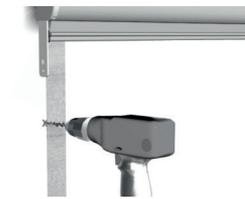
● Bohren Sie mit einem Bohrer Ø 6 mm die Löcher an den markierten Stellen in die Wand und stecken Sie die Dübel ein.
