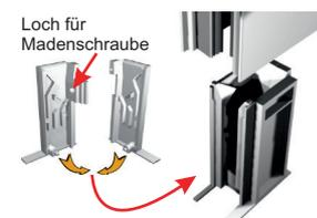
● Die Sockel (77) zusammenstecken, in die Führungsschienen schieben und mit Madenschraube (7) befestigen.
