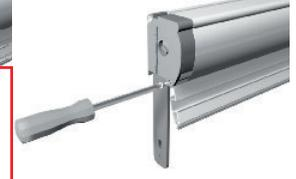
Schrauben Sie das Kopfteil (10) mit zwei Schrauben 4x25 am Rollokasten an.
