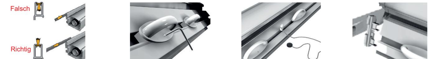
Wenn die Bürste mit dem Rücken nach vorne in die Griffschiene eingeschoben ist, dann umdrehen.
