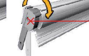
Drehen Sie die Feder (1) von Hand im Uhrzeigersinn, damit die Rollospannung entsteht. Siehe Tabelle.
