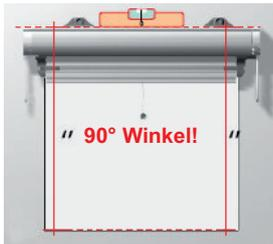
● Achten Sie darauf, das der Rollokasten in der Waage angebracht wird und die Führungsschienen zu diesem im **90° Winkel** sind!
