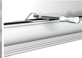
● Befestigungswinkel (81) mit Schrauben 3,5x40 anschrauben.
