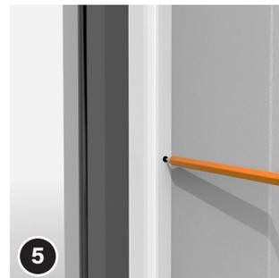
Die vorgebohrte Fliegengittertür wieder an die Montageposition halten und durch die Bohr-löcher im Montagerahmen die Bohrstellen auf dem Türrahmen markieren.
