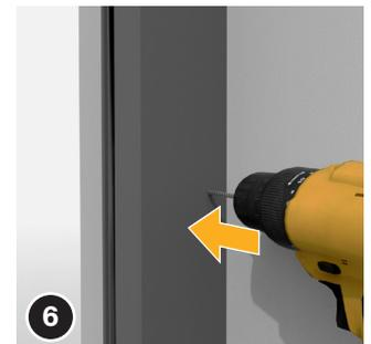
Die Fliegengittertür wieder beiseite legen und die angezeichneten Löcher mit einem kleineren Bohrer (z. B.  $\varnothing$  3 mm) aufbohren.
