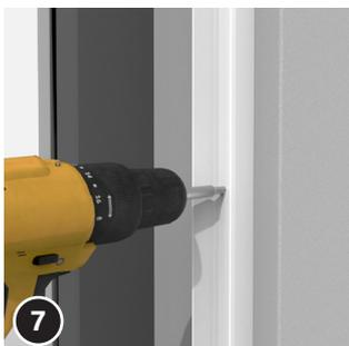
Nun den Montagerahmen mit den beiliegenden Schrauben 4 x 55 **(11)** festschrauben.
