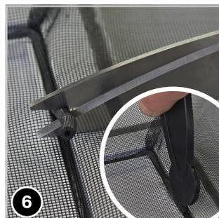
Den Gummikeder am Ende ca. 10 mm länger lassen; dann mit Messer oder Schere abschneiden. Anschließend das Ende in Nut stecken und Wulst mit Kedereindrücker eindrücken.
