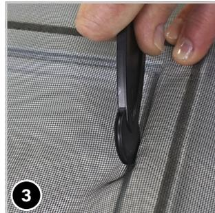
Zuerst das Gewebe mit dem Kedereindrücker **ohne Gummikeder** in der Nut des Rahmensystems vordrücken. Das erleichtert das Einziehen mit Netz.
