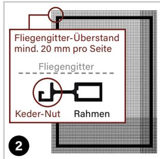
Das Rahmensystem mit der Keder-Nut nach oben auf eine saubere Unterlage legen und das Fliegengitter auf dem Rahmensystem ausbreiten.
