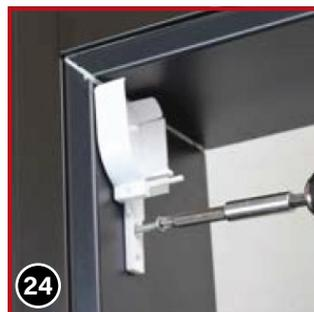
In die gebohrten Löcher die Dübel einstecken und zuerst die Endkappe ⑩ mit einer Schraube 3,5x40 anschrauben.
