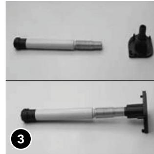
Rücklaufbremse (40) mit einer Linksrotation (also gegen den Uhrzeigersinn) auf den runden „Nippel“ des rechten Lagers (2) aufdrehen. Die Bremse wird nur aufgedreht und nicht gespannt.
