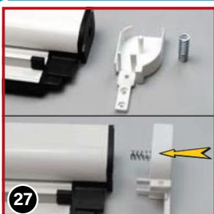
Zwischen Endkappe DX/R ⑩ und Rollokasten die Klemmfeder ③1 anbringen und dann die Endkappe auf den Kasten aufstecken.
