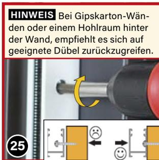
**Mit Dübel:** Bohren Sie die Löcher Ø 6 mm im Fensterrahmen; danach Dübel einstecken.
