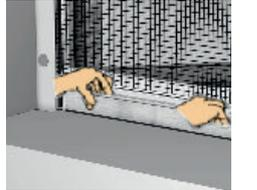
● Setzen Sie das Rollo mit den Führungsschienen wieder ein. Schrauben Sie an den vorgebohrten Positionen das Rollo mit den Schrauben 4x40 an der Wand an.
