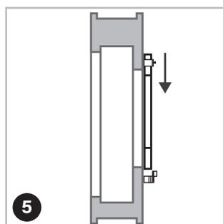
Positionnez le cadre de tension entre les deux verrous supérieurs et placez-le sur les verrous inférieurs.
