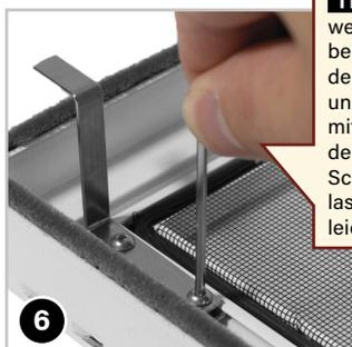
**ACHTUNG** Schieben Sie die Schlitten mit den angebrachten Winkelaschen nur bis zur Innenkante der Profilmutter! Sonst lässt sich der Rahmen später nicht einhängen.
