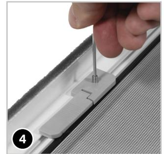
Drehen Sie nun die im Griff befindliche Schraube mit dem Innensechskant (15) vorsichtig fest – drehen Sie die Schraube nur so weit, bis diese fast im Griff verschwindet. Damit wird der Griff an seiner Position fixiert.
