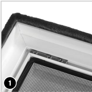
Schieben Sie die sog. Schlitten für die Befestigung der Winkelaschen in die Ecken des Rahmens (diese befinden sich bereits im Rahmen). In jeder Rahmenecke soll ein Schlitten sein.
