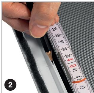
À l'aide d'une règle, déterminez le centre du cadre en hauteur. Marquez ce centre sur le cadre avec un crayon (par exemple, un crayon à papier).
