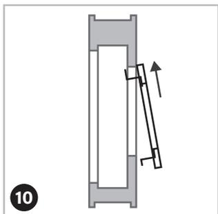
Glissez ensuite le cadre, en insérant d'abord les pattes d'angle supérieures dans la feuillure supérieure de la fenêtre.
