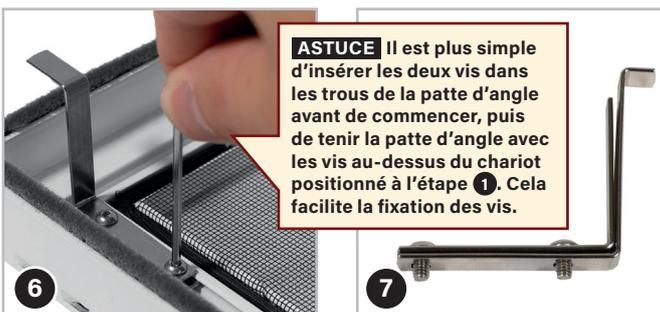
**ASTUCE** Il est plus simple d'insérer les deux vis dans les trous de la patte d'angle avant de commencer, puis de tenir la patte d'angle avec les vis au-dessus du chariot positionné à l'étape 1. Cela facilite la fixation des vis.
