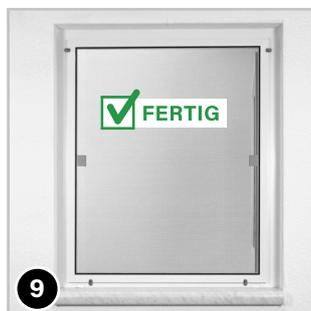
Sobald der Rahmen positioniert wurde, drehen Sie die oberen und unteren Vorreiber so, dass der Rahmen von diesen fixiert wird.
