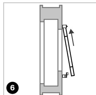
Messen Sie nun die Positionen der oberen Vorreiber (12) aus. Diese sitzen – anders wie die unteren Vorreiber – seitlich am Fensterrahmen. Gehen Sie dazu vom oberen Rand der Fensteröffnung 50 mm nach unten. Markieren Sie die Stelle. Dann 22 mm nach außen. Markieren Sie die finale Position des ersten, oberen Vorreibers. Wiederholen Sie die Montageschritte der Vorreiber auch für die andere Seite.
