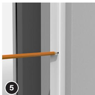
Die vorgebohrte Fliegengittertür wieder an die Montageposition halten und durch die Bohrlöcher im Montagerahmen die Bohrstellen in der Laibung markieren.
