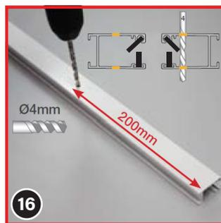
À environ 200 mm (20 cm) de l'autre extrémité des rails de guidage, percez un autre trou de Ø 4 mm à travers les deux parois. Pour les rails de guidage mesurant plus de 150 cm de long, effectuez un trou supplémentaire de Ø 4 mm au centre.
