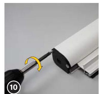
Insérez ensuite le ressort tendu (1) complètement dans le caisson et fixez-le avec deux vis 4 x 16.
