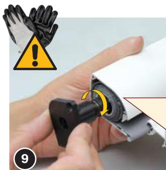
**Attention : Risque de blessure** Lors de la tension du ressort, il est possible que le palier « revienne brusquement » en cas de glissement des doigts. Pour plus de sécurité, utilisez des gants adaptés pour cette étape.
