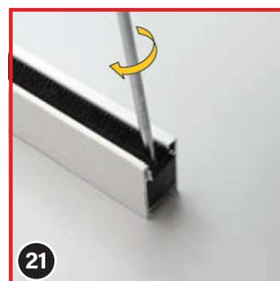
Après avoir inséré les socles (5) dans les rails de guidage, vissez-les légèrement avec 2 à 3 tours seulement. Cela permettra d'effectuer des ajustements en hauteur jusqu'à la fin de l'installation.
