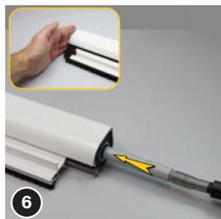
Insérez le palier droit (2) dans le tube du filet dans le caisson du store, comme illustré (veillez à aligner les encoches du palier et du frein de retour, le cas échéant). Maintenez l'autre extrémité pour éviter que le tube ne soit poussé hors du caisson.
