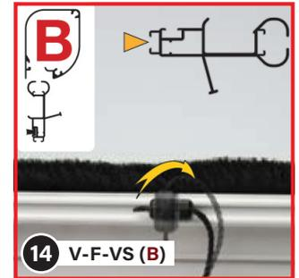
Si souhaité : Insérez la corde de traction (30) dans la rainure libre située sous le rail de poignée, puis fixez-la en effectuant une rotation de 90°.
