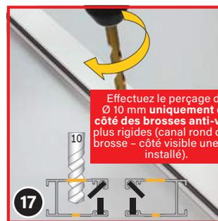
Agrandissez les trous avec un foret de Ø 10 mm. Ces trous serviront à insérer ultérieurement les bouchons de protection de 10 mm (32). Avec des brosses standard, il n'est pas important de quel côté vous réalisez les perçages de 10 mm.
