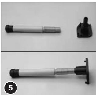
Si commandé : vissez le frein de retour (40) sur le « téton » rond du palier droit (2) en effectuant une rotation vers la gauche (dans le sens inverse des aiguilles d'une montre). Le frein doit être simplement vissé, sans être tendu.
