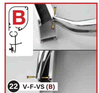
Si les rails de guidage ne reposent pas directement sur le rebord de la fenêtre, pincez leurs extrémités avec une pince. Cela empêchera les brosses de glisser hors des rails.
