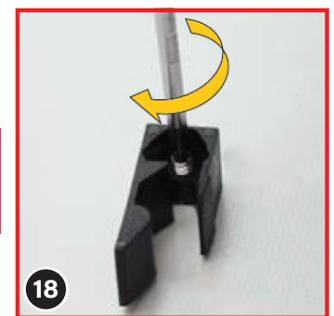
Vissez une vis sans tête (7) à l'intérieur de chaque socle à l'aide de la clé hexagonale (50) fournie. Vissez uniquement jusqu'à ce que la pointe de la tête de la vis sans tête soit presque visible sur le côté lisse du socle (5).
