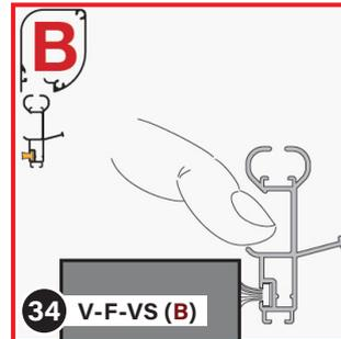
Déterminez maintenant la position finale du rail de poignée. Pour ce faire, tirez le rail de poignée vers l'extrémité inférieure de l'embrasure de fenêtre comme indiqué. Veillez à ce que le bout de vos doigts puisse encore bien pénétrer dans la rainure de la poignée. Les plinthes doivent être fixées à la hauteur du rail de poignée (étape suivante).
