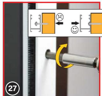
**Avec chevilles :** Insérez les chevilles dans les trous et fixez les rails de guidage avec des vis 4 x 40.
