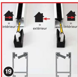
Disposez les rails de guidage et les socles (5) comme indiqué sur l'image. La partie la plus longue du socle doit être orientée vers l'extérieur (côté jardin). Si une brosse anti-vent a été choisie, cette orientation correspond au côté de la brosse longue et rigide.
