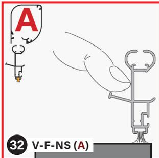
La brosse de la poignée-rail doit être complètement étanche par rapport à l'appui de fenêtre. Pour que ce soit le cas, les socles (5) doivent être poussés jusqu'à l'extrémité des rails de guidage et y être vissés avec la clé hexagonale (50).
