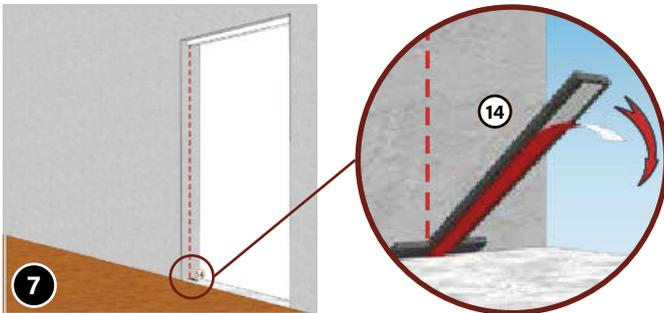
Richten Sie die Kastenhalterungen (14) für die Rollokasten aus (siehe gestrichelte rote Linie).
