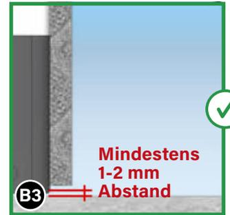
Für eine einwandfreie Bedienung müssen **mindestens 1-2 mm Abstand** zwischen Unterkante Griffschiene und Boden vorhanden sein.
