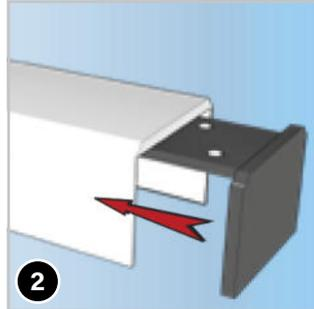
Falls auf der gegenüberliegenden Seite des Rollokastens keine Wand ist, benutzen Sie die optionale Abdeckplatte (21) als seitliche Abdeckung an der U-Schiene. Ansonsten können Sie die Abdeckplatte ignorieren.
