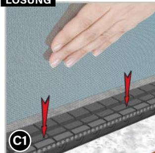
Lassen Sie in diesem Fall den Kasten unbedingt offen stehen, bis das Netz wieder eingefädelt wurde (sonst Faltenbildung)!
