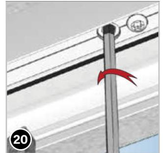
Verstellen Sie dann die großen Gewindeschrauben in den Justierblöcken (15) in der Höhe mit Hilfe des Sechskantschlüssels, bis die Z-Schiene parallel zum Boden ist. Schrauben Sie die Schrauben (27) dann fest an. **ACHTUNG** Überprüfen Sie mit einer Wasserwaage den Stand der Z-Schiene (3)!
