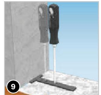
Anschließend Dübel einstecken und Kastenhalterungen anschrauben. Alternativ können sie mit einem doppelseitigen Kleband ganz einfach am Boden angeklebt werden.
