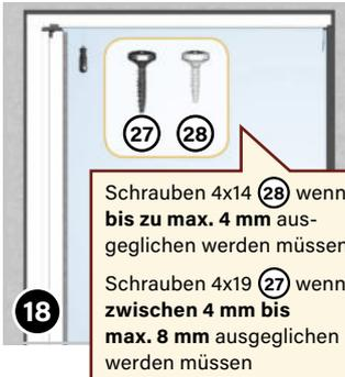
Schrauben 4x14 (28) wenn bis zu max. 4 mm ausgeglichen werden müssen
