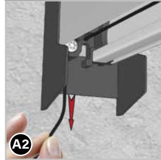
Spannen Sie dann die dickere Schnur etwas stärker und ziehen Sie die Schraube am Seilschuh erneut fest. Testen Sie den Lauf des Rollos erneut.
