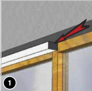
Die U-Führungsschiene (2) wird an die Decke (im Sturz) montiert (siehe nächster Montageschritt).
