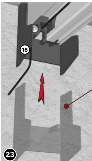
Als Abschluss wird die Führungshaube (16) von unten auf das Ende der montierten Führungsschiene geschoben.
