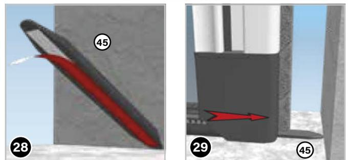
Der Kastenanschlag (16) ist ein optionales Zubehör, welches dafür sorgt, dass die Griffschiene des Rollos in Endposition fixiert wird.
