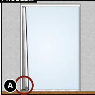
Die Griffschiene des Rollos kippt beim Öffnen oder lässt sich nicht richtig schließen. Die Ursache liegt hierbei oft darin, dass die dickere Schnur in der Z-Schiene ③ nicht stark genug gespannt ist.
