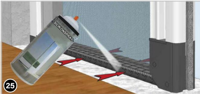
Wir empfehlen vor der ersten Anwendung die Kettenglieder des Insektenschutzrollos mit Silikonspray einzusprühen. Diesen Vorgang sollten Sie in regelmäßigen Abständen wiederholen, z. B. alle 3-6 Monate (je nach Bedienungshäufigkeit), oder wenn Sie merken, dass das Rollo beim Öffnen und Schließen etwas schwergängiger wird.
