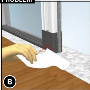
Das Rollo läuft zu stramm. Nehmen Sie zum Test ein Papierblatt zur Hand. Sollte sich dieses im unteren Bereich nicht mehr unter die geöffnete Griffschiene schieben lassen, so müssen Sie die Z-Schiene ③ regulieren.
