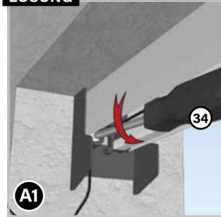
Rollen Sie das Rollo zuerst auf (Griffschiene muss sich am Kasten befinden). Lockern Sie dann die Schraube am Seilschuh (Teil am Ende der Z-Schiene ③) mit dem Schlüssel T15 ③ ein wenig.
