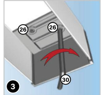
Stecken Sie diese vor dem Anschrauben der U-Führungsschiene am Sturz auf der Anschlagseite auf (die Anschlagseite ist die Seite, welche sich gegenüber des später montierten Rollokastens befindet). Schrauben Sie die Abdeckplatte mit Hilfe des Sechskantschlüssels 2,5 mm (30) und den Gewindestiften 5x6 mm (26) leicht an.
