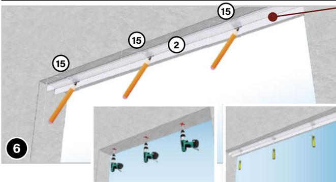
Markieren Sie die Bohrstellen in Decke/Sturz durch die Löcher in der U-Führungsschiene (2) und den eingeschobenen Justierblöcken (15). Entfernen Sie die U-Führungsschiene und bohren Sie die Löcher. Je nach Untergrund/Mauerwerk bohren Sie große Löcher oder nur vor.
