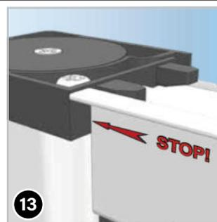
(11) Stecken Sie die Z-Schiene (3) wie abgebildet von leicht schräg oben auf das Laufrädchen des Rollokastens (1) auf.
