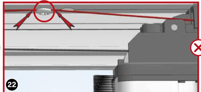
**ACHTUNG** Überprüfen Sie den Verlauf der Schnüre nach dem Anschrauben der Z-Schiene (3) erneut. Diese dürfen sich beim Anschrauben nicht verklemt haben.
