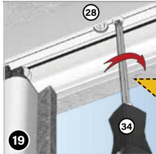
Schrauben Sie die Z-Schiene (3) zunächst mit den längeren Schrauben 4x19 (27) durch die noch freien Löcher der Justierblöcke (15) in die U-Führungsschiene (2) locker an (**noch nicht festziehen!**).
