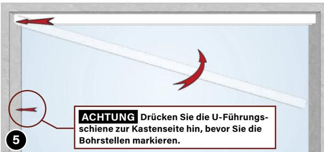
**ACHTUNG** Drücken Sie die U-Führungsschiene zur Kastenseite hin, bevor Sie die Bohrstellen markieren.
