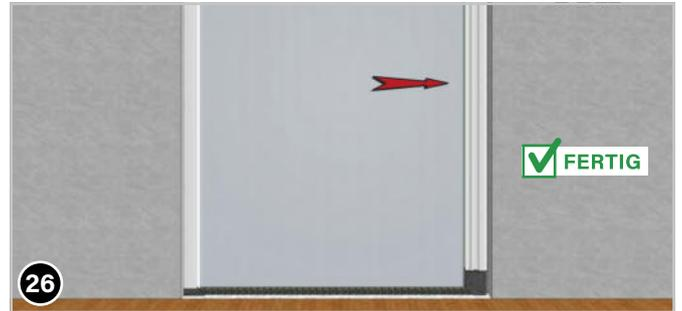
Ziehen Sie die Griffschiene der Rolllotüre bis zum Ende der Z-Schiene (3) und überprüfen Sie dabei deren Lauf. Wichtig ist, dass die Griffschiene nicht kippt und am Ende, also an der Anschlagseite, von oben bis unten mit der Dichtungsbürste zur Wand hin sauber abdichtet. **Beachten Sie bitte auch noch die PFLEGEHINWEISE, damit Sie das Rollo noch lange vor Insekten schützen wird!**
