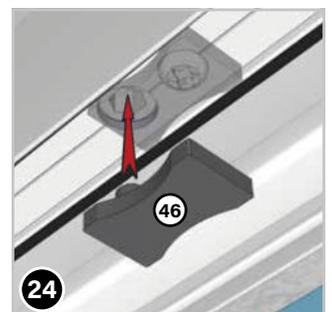
Nun abschließend noch die Abdeckstopfen (46) auf die Schrauben und Löcher im Z-Profil (3) aufstecken.
