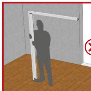
**ACHTUNG** Die aufgesteckte Z-Schiene ③ am Kasten ① darf während der restlichen Montage nicht losgelassen werden, bis diese vollständig an der U-Führungsschiene ② angeschraubt wurde! Möglichst waagrecht halten!
