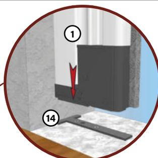
Im unteren Bereich den Kasten ① auf die Kastenhalterung ⑭ aufstecken. Dadurch wird der Kasten an seiner Position fixiert.
