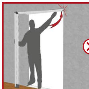
Bringen Sie den Kasten ① in Position, indem Sie ihn mitsamt der Z-Schiene ③ etwas schräg in die U-Führungsschiene ② „einfädeln“ (erst oben ①, dann unten ②).
