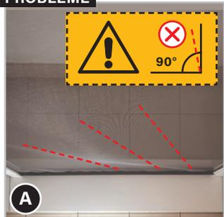
A Cela indique que la cassette à enrouleur (1) et le rail de compensation ne sont pas à un angle de 90°.
