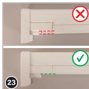
**ATTENTION** Consultez l'image ci-dessus ! Le rail de compensation et le rail de guidage adjacent (2) doivent être alignés l'un avec l'autre !
