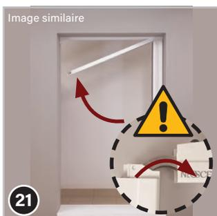
Ensuite, relevez délicatement les rails de compensation et insérez-les dans les cassettes à enrouleur sans exercer de pression.
