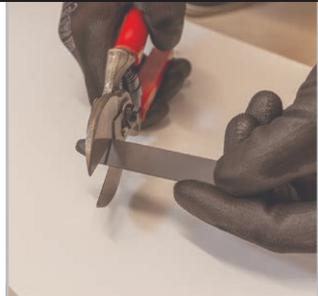
Avec une pince, coupez une extrémité saillante en forme de flèche de la butée pour rail de poignée (8).
