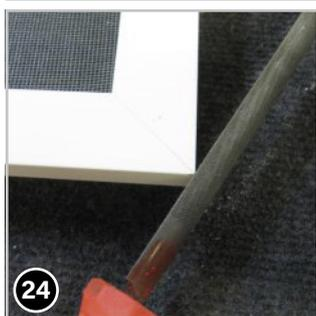
Zum Schluss noch die Aussenkanten des Spannrähmens mit einer Feile leicht abraten.
