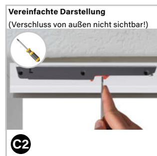
Um das Problem zu beheben nehmen Sie z. B. einen etwas längeren Schraubendreher. Führen Sie diesen von unten in die Laufschiene (A) ein und zwar an der Position, wo der Schiebetürflügel "aneckt".
