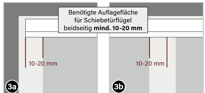
Die Laufschiene **mit den großen Löchern nach außen** über die zu abdeckende Türöffnung ca. 10-20 mm überstehen lassen. So kann die Bürste am Schiebetürflügel zum Türrahmen und Mittelsteg der Schiebetür hin ideal abdichten.
