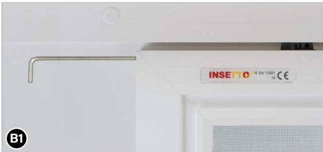
Mittels des beiliegenden Spezialschlüssels TX (2) (oder eines langen Schraubendrehers) können Sie die Neigung der Laufwagen von außen an der Stirnseite durch Auf- und Zudrehen der Stellschraube anpassen. Achten Sie darauf die Stellschraube langsam und nicht zu weit auf-/zuzudrehen. **ACHTUNG** Überprüfen Sie nach einer Umdrehung durch die Bedienung des Schiebetürflügels immer gleich, ob eine weitere Umdrehung wirklich notwendig ist!
