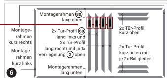
Profile zur Orientierung vor dem weiteren Zusammenbau auf eine weiche Unterlage legen. Überprüfen Sie nun die bisherige Montage.
