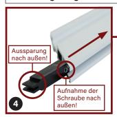
Je eine Verriegelung (2) mit dem "Krokodilsmaul" nach außen in je ein langes Tür-Profil (6) einschieben. Profile dafür spiegelverkehrt hinlegen siehe Montageschritt (6).
