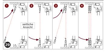
Nun werden die Schiebetüren innen und außen im Montagerahmen angebracht. Türen zuerst oben, dann unten "einfädeln".
