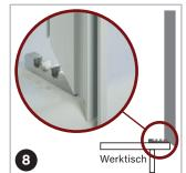
an Werktisch-Kante anlegen. Kurzes Tür-Profil bis Anschlag nach unten **ganz gerade** auf den Eckverbinder aufschieben – auf anderer Seite zweiten Eckverbinder aufschieben.
