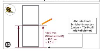
Position der Sprosse (1) ermitteln; dazu mit einem Maßband ab Unterkante des Schiebetür-Rahmens bis Unterkante Sprosse messen. Dann die Stelle mit einem Stift auf beiden Seiten der Tür-Profile (1) markieren.
