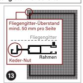
Schiebetüren mit Bürste nach oben auf saubere Unterlage legen und die Fliegengitter (10) auf den Türen ausbreiten.
