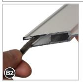
Zuerst in zwei kurze und zwei lange Schiebetür-Profile (6) in die innere Nut eine Dichtungsbürste (8) einziehen und an den Ecken mit einem Cuttermesser abschneiden.
