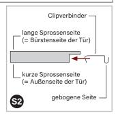
ACHTUNG Keine Korrektur möglich! Einmal eingeklopft lassen sich die Clipverbinder nicht mehr lösen!
