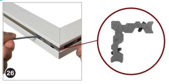
Nun einen Eckverbinder ① für Montagerahmen in ein langes und ein kurzes Montagerahmen-Profil ② einschieben. Die Profile an der Ecke so ausrichten, dass diese sauber zusammenstoßen. Danach den Eckverbinder mit dem beiliegenden Sechskantschlüssel ③ in beiden Montagerahmen-Profilen anschrauben. So auch mit den restlichen Profilen vorgehen, bis Sie einen an den Ecken geschlossenen Montagerahmen erhalten.
