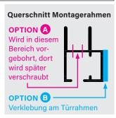
Der Montagerahmen (80) wird als nächstes zusammengebaut. **OPTION** A Montagerahmen vorbohren und dann oben, unten und seitlich in der Leibung verschrauben.
