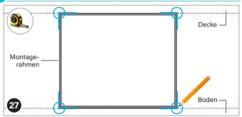
Den Montagerahmen (a) am Türrahmen ausrichten. Anschließend die Ecken aller Seiten des Montagerahmens am Türrahmen mit einem Bleistift markieren. Den Montagerahmen wieder abnehmen und die Schutzfolie des Klebebands (4) jetzt vorsichtig abziehen.
