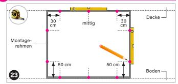
Den Montagerahmen zwischen der Leibung ausrichten – **dabei eine Wasserwaage verwenden.** Anschließend die Bohrlöcher aller Seiten auf der Wandleibung markieren. **TIPP** Wir empfehlen drei Bohrungen in der Breite und zwei in der Höhe der Profile vorzunehmen (ca. 30 cm von außen, 50 cm von Boden/Decke).
