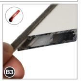
Dann in einem der beiden langen Türprofile (a) (steht Ihnen frei welches) zusätzlich eine Dichtungsbürste (8) in der äußeren Nut einfügen. Wieder an den Enden abschneiden.
