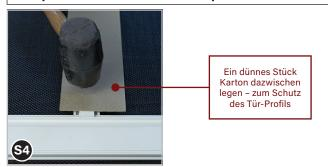
Die Sprosse (9) mit gerundeter Seite der Clipverbinder (3) nach unten zuerst auf einer Seite mit einem Gummihammer (dazwischen, zum Schutz des Tür-Profils (6), z. B. ein dünnes Stück Karton legen) in die Keder-Nut der Tür-Profile einklopfen – anschließend die zweite Seite ebenso einklopfen.
