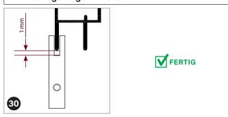
Die Verriegelungen ② in den Türprofilen lösen, nach oben schieben und mit 1 mm Abstand zum Montagerahmen mittels Sechskantschlüssel fixieren.
