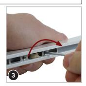
Rollgleiter (4) mittels Sechskantschlüssel (5) im äußeren Tür-Profil-Bereich (ca. 100 mm von Kante) rechts und links anschrauben.
