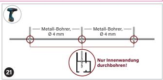
Anschließend die Löcher im **inneren Bereich (Innenwandung)** der Profile (80) bohren. TIPP Die Bohrstellen dürfen auch etwas verschoben werden, falls Sie an einer bestimmten Stelle am Boden/Decke nicht anschrauben können.
