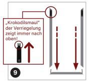
2x Tür-Profile lang 60 mit Tür-Profil kurz mit Rollgleiter 4 verbinden – dabei auf die richtige Ausrichtung der Bürste achten!
