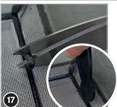
Gummikeder (9) am Ende ca. 10 mm länger lassen; dann mit Messer oder Schere abschneiden. Anschließend das Ende in Nut stecken und Wulst mit Kedereindrücker (6) eindrücken.
