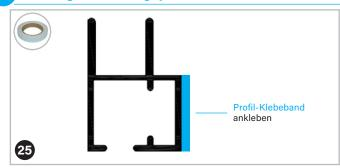
Die Klebefläche am Montagerahmen (a) muss frei von Ölen, Fetten, sowie Staub und Schmutz sein. Profil-Klebeband (4) wie im Bild oben markiert über die ganze Länge am Montagerahmen ankleben.
