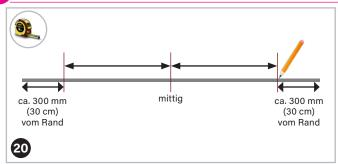
Zunächst die Bohrlöcher im Innenbereich der langen und kurzen Montagerahmne-Profile (a) ausmessen und mit einem Stift markieren – bei den kurzen Profilen (Höhen) 2 Bohrlöcher; bei den langen Profilen (Breite) 3 Bohrlöcher.
