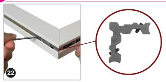
Nun einen Eckverbinder ① für Montagerahmen in ein langes und ein kurzes Montagerahmen-Profil ② einschieben. Die Profile an der Ecke so ausrichten, dass diese sauber zusammenstoßen. Danach den Eckverbinder mit dem beiliegenden Sechskantschlüssel ⑤ in beiden Montagerahmen-Profilen anschrauben. So auch mit den restlichen Profilen vorgehen, bis Sie einen an den Ecken geschlossenen Montagerahmen erhalten.
