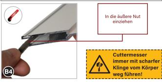
In zwei kurze und zwei lange Schiebetür-Profile 60 in die äußere Nut eine Dichtungsbürste 8 einziehen und an den Ecken mit einem Cuttermesser abschneiden.
