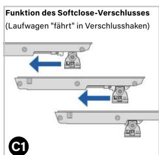
Damit der Softclose-Verschluss **10** gut funktioniert, muss der Flügel der Schiebetür in den Haken des Verschlusses greifen können. Dies geht nur, wenn sich der Haken in einer geöffneten Position befindet.
