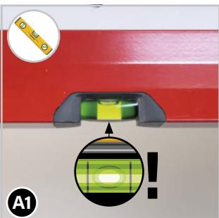
Prüfen Sie zuerst, ob sich die obere Laufschiene **A** in der Waage befindet. Wenn diese sich nicht in einer exakt waagrechten Position befindet, ist der Schiebetürflügel nicht positionierbar.
