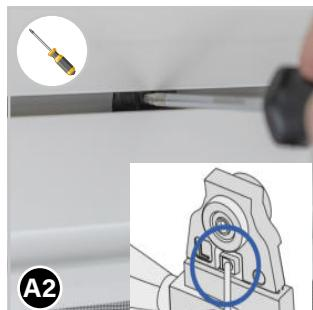
Entfernen Sie in diesem Fall den Schiebetürflügel mit Druck auf die mittleren Rastnasen der Aufhängungen (z. B. mit einem Schraubendreher). Danach die Abdeckstöpsel **9** von den Bohrlöchern abnehmen.
