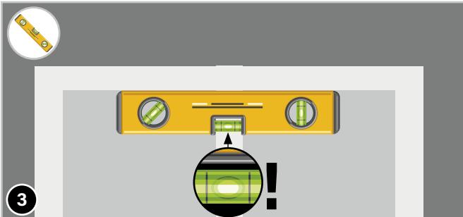
Die Laufschiene (A) wird an der Innenkante des Türrahmens ausgerichtet. Dazu muss die Innenkante des Türrahmens (Türfalte) waagrecht verlaufen. Prüfen Sie dies mit einer Wasserwaage.
