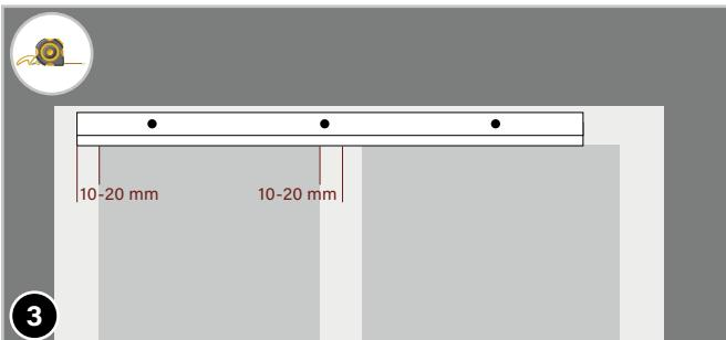
Die Laufschiene mit den großen Löchern nach außen über die zu abdeckende Türöffnung ca. 10-20 mm überstehen lassen. So kann die Bürste am Schiebetürflügel zum Türrahmen und Mittelsteg der Schiebetür hin ideal abdichten.
