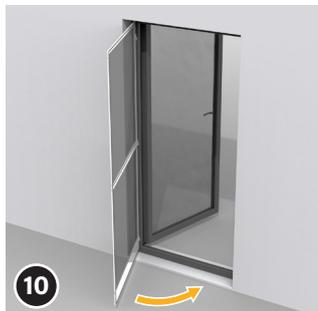
10 Die Fliegengittertür schließen. Die Magnete sind nun an ihrer idealen Position angeklebt.
