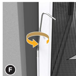
Die Feder mit dem mitgelieferten 3 mm Sechskantschlüssel mit Kugelkopf mit 2 Umdrehungen vorspannen.
