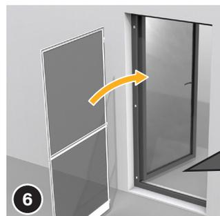
Anschließend die Fliegengittertür in den befestigten Scharnieren am Türrahmen einhängen. Dazu die Verbindungsstifte für Scharniere (5) von oben jeweils durch zwei Scharnierhälften hindurchstecken.
