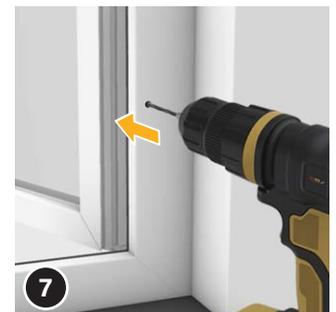
Legen Sie den Montagerahmen wieder beiseite und bohren Sie die angezeichneten Löcher mit einem kleineren Bohrer (z. B. Ø 3 mm) vor.
