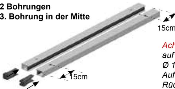
**Achtung!** Nur Bohrloch auf Sichtseite mit Bohrer  $\varnothing$  10 mm vergrößern. Auf keinen Fall die Rückseite!
