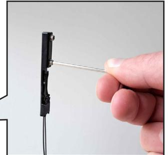
**TIPP** Die Blöcke auf den Sechskantschlüssel (7) stecken. So können Sie die Blöcke präzise in die Aussparungen einsetzen.
