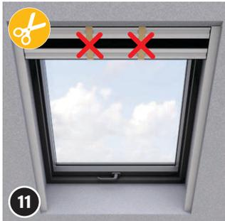
Lösen Sie das Klebeband, um die Griffschiene zu lösen.
