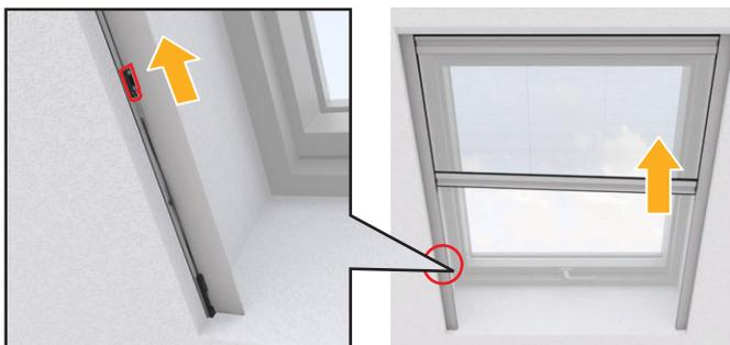
**TIPP** Bei schiefer Griffschiene: Die oberen Justierblöcke spannen die Griffschiene auf der jeweils gegenüberliegenden Seite. Sollte z.B. die Griffschiene rechts herunterhängen, bewegen Sie den linken Justierblock nach oben.
