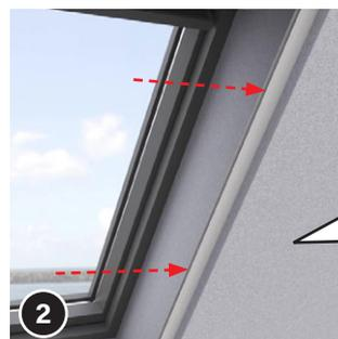
Halten Sie die Führungsschienen an die gewünschte Position in der Laibung. Markieren Sie nun die Bohrpunkte zur Befestigung des Plissees.
