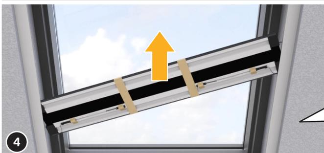
Setzen Sie den Plisseekasten in die Führungsschienen ein. Achten Sie dabei darauf, dass die Endkappen mit den eingebauten Federstiften (13) nach oben zeigen.
