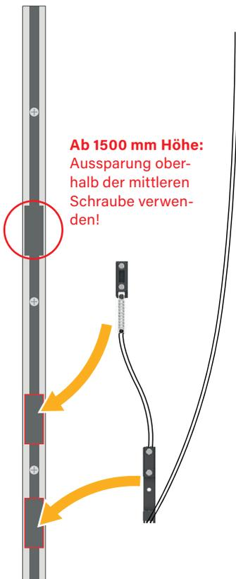
Ab 1500 mm Höhe: Aussparung oberhalb der mittleren Schraube verwenden!
