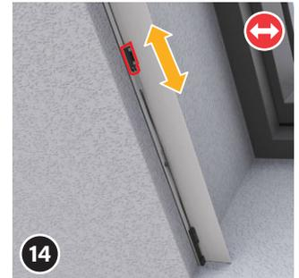
Bewegen Sie den Justierblock nach oben oder unten. Fixieren Sie den Justierblock wieder und beobachten Sie die Position der Griffschiene sowie die Netzspannung. Wiederholen Sie den Vorgang auf beiden Seiten, bis die Griffschiene gerade ist, von alleine stehen bleibt und sich das Plissee problemlos öffnen/schließen lässt.
