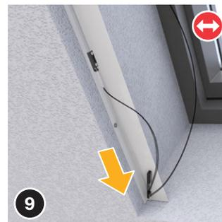
Legen Sie den zweiten Justierblock (15) oder (16) in die Aussparung. Schieben Sie ihn nach unten. Achten Sie dabei darauf, dass die Schrauben nach oben zeigen.
