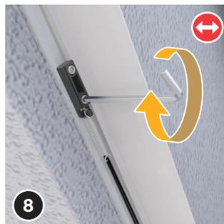
Schrauben Sie den Justierblock mit dem beiliegenden Sechskantschlüssel (7) fest.
