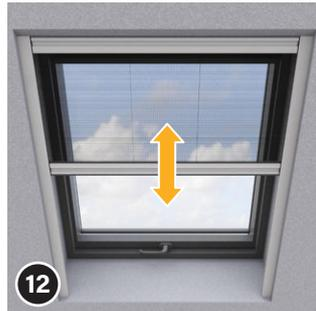
Schließen und öffnen Sie das Plissee mehrmals, um die Funktion zu testen.
