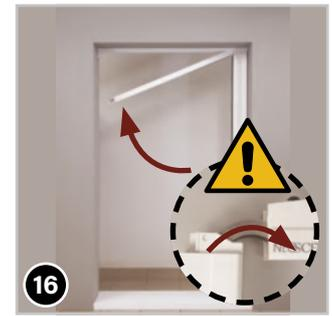
Anschließend vorsichtig die Ausgleichsschiene nach oben klappen und am Rollokasten ohne Druck einstecken.
