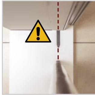
Verkleben Sie diesen anschließend am Boden. Die Position muss so gewählt sein, dass sich die Griffschiene in Endposition exakt in einer senkrechten Lage befindet.
