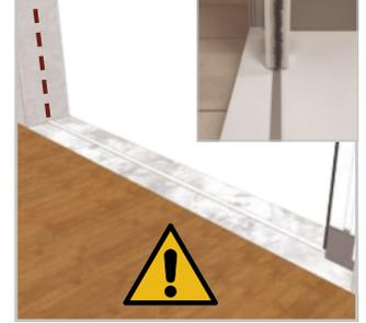
Die Bodenschiene ④ empfehlen wir bei sehr schrägen Böden. Diese muss exakt so montiert werden, dass die Griffschiene bei Bedienung seitlich nicht wegkippen kann.
