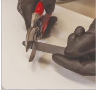
Zwicken Sie ein überstehendes, pfeilartiges Ende des Anschlags für die Griffschiene ⑨ mit einer Zange ab.
