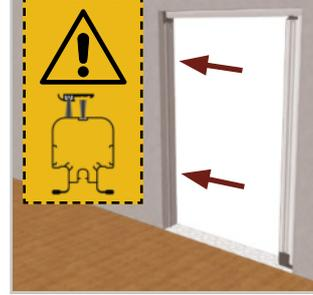
Das Bürstenprofil ⑤ gegenüber der Griffschiene anbringen und zwar so, dass die Bürste des Profils ein wenig versetzt zur Bürste der Griffschiene abdichtet (obiges Bild beachten!).
