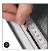
Schieben Sie die Schlitten für die Befestigung der Winkellaschen in die Ecken des Rahmens. In jeder Rahmenecke soll ein Schlitten sein. Ermitteln Sie dann mit Hilfe eines Maßstabes die Mitte Ihres Rahmens in der Höhe. Markieren Sie die Mitte des Rahmens in der Höhe mit einem Stift (z. B. Bleistift).
