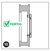
Nun können Sie den Rahmen loslassen. Ihr Fenster kann mit angebrachtem Fliegengitter geschlossen werden. Die Winkellaschen drücken sich sanft in die Gummidichtung des Fensterrahmens / Fensterflügels.
