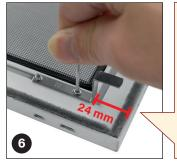
Schrauben Sie die Winkellaschen mit je zwei Schrauben 3 und dem beiliegenden Innensechskant in den entsprechenden Löchern der Schlitten an. Nun sind die Winkellaschen fest fixiert und der Rahmen kann eingehängt werden.
