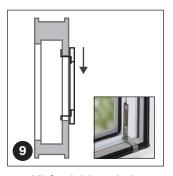
Anschließend ziehen Sie das Fliegengitter an den Fensterrahmen heran und hängen es über den unteren Fensterfalz ein.
