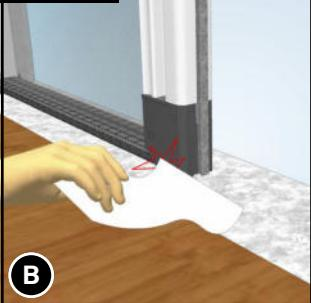
Das Rollo läuft zu stramm. Nehmen Sie zum Test ein Papierblatt zur Hand. Sollte sich dieses im unteren Bereich nicht mehr unter die geöffnete Griffsschiene schieben lassen, so müssen Sie die Z-Schiene (3) regulieren.
