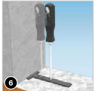
Anschließend Dübel einstecken und Kastenhalterungen anschrauben. Alternativ können sie mit einem doppelseitigen Klebeband ganz einfach am Boden angeklebt werden.
