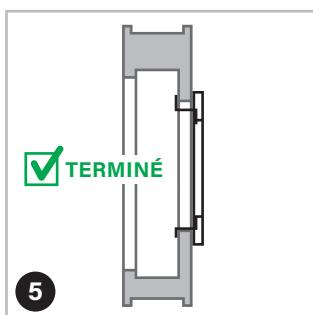
Vous pouvez maintenant relâcher le cadre. Votre fenêtre peut être fermée avec la moustiquaire installée. Les pattes d'angle exercent une légère pression sur le joint en caoutchouc du cadre ou du battant de la fenêtre.
