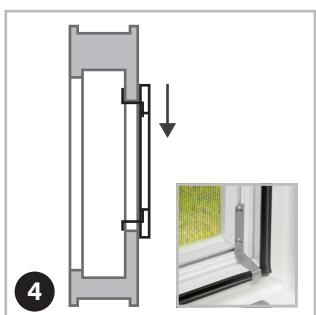
Ensuite, rapprochez la moustiquaire du cadre de la fenêtre et insérez-la dans la feuillure inférieure de la fenêtre.
