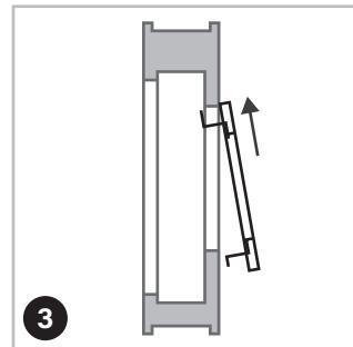
Insérez ensuite le cadre dans le feuillure supérieure de la fenêtre, en commençant par les pattes d'angle supérieures.
