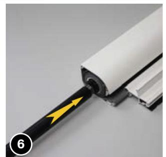
Lager mit Feder (1) auf der anderen Seite soweit einschieben, dass diese noch etwa handbreit raus steht.
