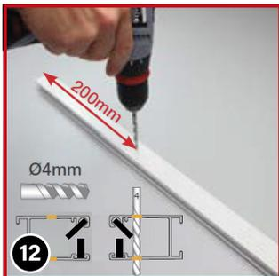
**Führungsschienen mit Antiwindbürsten** spiegelverkehrt zueinander legen (siehe Bild) – bei Standardbürsten ist das egal. Bohren Sie im Abstand von ca. 200 mm (20 cm) zum Ende der Führungsschienen ein Loch  $\varnothing$  4 mm durch beide Wandungen.
