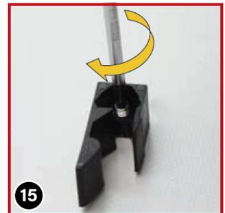
Schrauben Sie je eine Madenschraube (7) mit dem beiliegenden Sechskantschlüssel (50) von innen in die Sockel. Nur so weit, dass die Spitze des Kopfs der Madenschraube auf der glatten Seite des Sockels (5) fast raus schaut.
