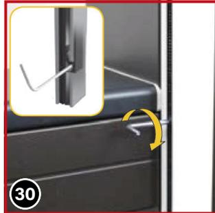
30 Richten Sie die Sockel ⑤ auf gleicher Höhe aus und befestigen Sie diese, indem Sie die Madenschrauben mehrmals mit dem Sechskantschlüssel ⑤⑩ festdrehen. Danach testen Sie den Verschluss und passen ggf. die Position der Sockel an.
