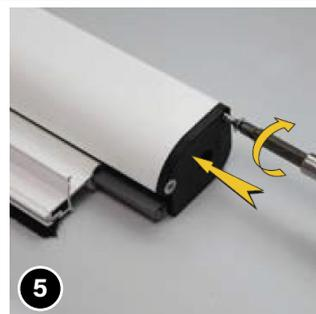
Das Lager (2) muss den Rollokasten auf allen Seiten abdichten. Dann mit Hilfe von zwei Schrauben 4x16 anschrauben. **ACHTUNG** Schrauben gerade einschrauben und nicht überdrehen, da sonst das Netz beschädigt werden kann!
