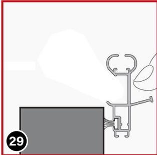
29 Ermitteln Sie nun die Endposition der Griffschiene. Ziehen Sie die Griffschiene dazu wie abgebildet ans untere Ende der Fensterleibung.
