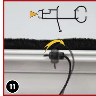
Soweit gewünscht: Zugschnur (30) in die freie Nut auf der Seite der Griffschiene einschieben und durch eine 90°-Drehung feststellen.
