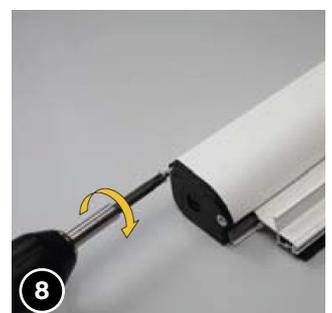
Danach die gespannte Feder (1) ganz in Kasten einstecken und mit zwei Schrauben 4x16 anschrauben. **ACHTUNG** Schrauben gerade einschrauben und nicht überdrehen, da sonst das Netz beschädigt werden kann!
