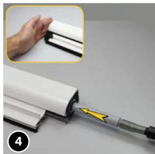
Lager rechts (2) wie abgebildet in die Netzswelle im Rollokasten einschieben (achten Sie auf die Einkerbungen am Lager/der Rücklaufbremse!). Halten Sie auf der anderen Seite dagegen, wenn die Netzswelle dabei herausgeschoben wird.
