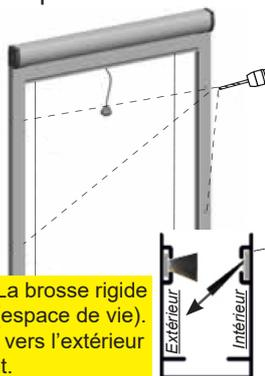
**Attention pour les brosses anti-vent :** La brosse rigide inclinée doit être orientée vers l'intérieur (espace de vie). Si les pointes des brosses sont orientées vers l'extérieur (côté ciel), repositionnez-les correctement.
