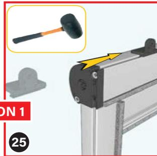
Nehmen Sie sich hier einen Gummihammer zur Hand, damit sich die Befestigungswinkel (13) leichter anbringen lassen. Diese sollten von jeder Seite aus ca. 10 cm weit eingeklopft werden.
