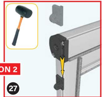
Nehmen Sie sich hier einen Gummihammer zur Hand, damit sich die Befestigungswinkel (13) leichter anbringen lassen. Diese sollten von jeder Seite aus ca. 10 cm weit eingeklopft werden.
