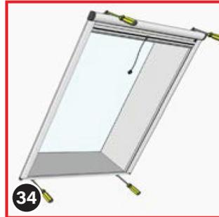
Halten Sie den Rollorahmen wieder an seine Position und schrauben Sie ihn mit den Schrauben 4x40 durch die Befestigungswinkel (15) an der Dachschräge an.
