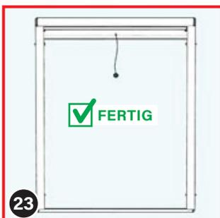
23 Nun sind der obere Rollokasten, die seitlichen Führungsschienen und das untere Abschlussprofil zu einem Rahmen miteinander verbunden.
