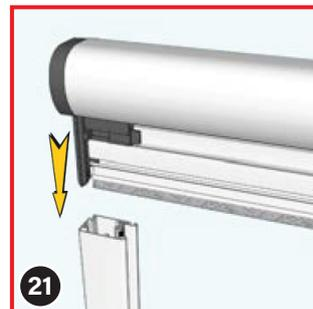
21 Fügen Sie den Rollokasten und die seitlichen Führungsschienen zusammen, indem Sie die Zungen der Kopfteile ② in die vorgesehene Nut innerhalb der Führungsschienen einstecken.
