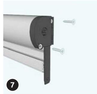
Schrauben Sie das rechte Kopfteil dann mit zwei Schrauben 3,5x30 am Rollokasten an. **ACHTUNG** Schrauben gerade einschrauben und nicht überdrehen, da sonst das Netz beschädigt werden kann!
