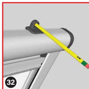
**ACHTUNG** Rollrahmen und Abschlussprofil müssen im 90°-Winkel mit den seitlichen Führungsschienen verbunden sein - Rahmen nicht verziehen!
