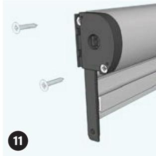
Das gespannte Kopfteil (2) am Kasten aufstecken und mit zwei Schrauben 3,5x30 anschrauben. **ACHTUNG** Schrauben gerade einschrauben und nicht überdrehen, da sonst das Netz beschädigt werden kann!
