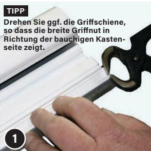
Zwicken Sie am Ende der beweglichen Schiene den Bürstkanal mit einer (Beiß-)Zange etwas zusammen, damit die Bürste nicht herausrutscht.
