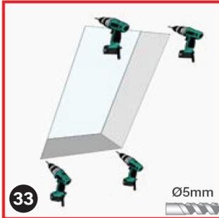
Nehmen Sie den Rollorahmen weg und bohren Sie die Löcher mit einem Bohrer Ø5 mm. Stecken Sie dann die mitgelieferten Universaldübel ein (ggf. ist es notwendig, dass Sie sich spezielle Hohlraum- oder Gipskartondübel im Baufachmarkt besorgen).
