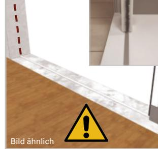
Die Bodenschiene (4) empfehlen wir bei sehr schrägen Böden. Diese muss exakt so montiert werden, dass die Griffschiene bei Bedienung seitlich nicht wegkippen kann.
