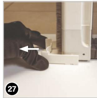
Im unteren Bereich den Abstandhalter von der Griffschiene entfernen (dieser diente dazu, dass das Rollo im richtigen Abstand zum Boden geführt wird).
