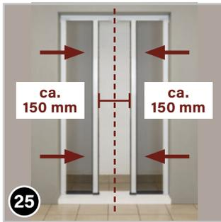
Öffnen Sie die beiden Insektenrollen so weit, dass sich zwischen deren Griffschienen noch ein Abstand von ca. 15 cm (150 mm) befindet.
