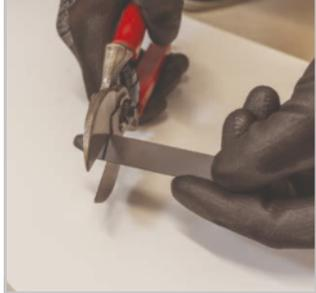
Zwicken Sie ein überstehendes, pfeilartiges Ende des Anschlags für die Griffschiene (9) mit einer Zange ab.
