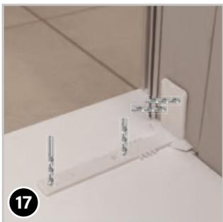
b) ... oder **mit Schrauben** am Boden verschrauben. Dazu je nach Untergrund zuerst vorbohren und ggf. Dübel einstecken.
