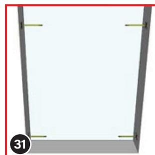
Nachdem Sie alle vier Bohrstellen markiert haben, nehmen Sie das Rollo wieder aus dem Dachfensterausschnitt heraus. Bohren Sie anschließend mit einem geeigneten Bohrer Ø6,5 mm die Löcher für die Haltestiftgehülsen. Falls Sie keinen Bohrer Ø6,5 mm besitzen, reicht ein Bohrer Ø6 mm dafür aus. Die Hülsen gehen dann aber strammer rein. Bei einer Holzkonstruktion und / oder wenn Sie keine Haltestiftgehülsen nutzen möchten, dann reicht ein Bohrer Ø 4,5 mm aus.
