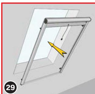
**TIPP** Ab hier ist es empfehlenswert zu zweit zu arbeiten. Halten Sie das ganze Rollo in der Dachfensterleibung dort an, wo es später angebracht werden soll. Richten Sie das Rollo so aus, dass die Bürste rundum optimal abdichtet.
