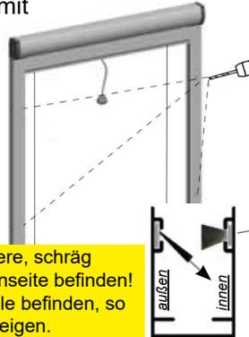
**Achtung bei Antiwindbürste:** Die steifere, schräg gestellte Bürste muss sich auf der Außenseite befinden! Würden sich an den Borstenspitzen Pfeile befinden, so würden diese nach innen (Wohnraum) zeigen.
