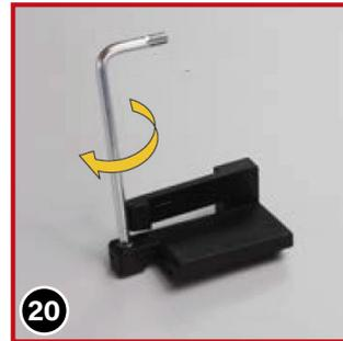
Drehen Sie in jeden der beiden Führungsstopper (22) je eine Madenschraube (7) ein.
