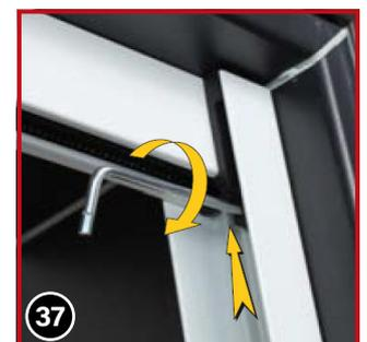
Schieben Sie den oberen Führungsstopper 22 auf die Führungsschiene auf. So weit, bis dieser hinter der Führungsschiene verschwindet und diese mit seinem Haken fixiert.
