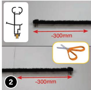
Bürste aus der Griffschiene herausziehen und rechts und links jeweils 30 cm abschneiden.
