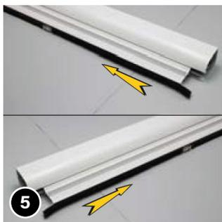
Nun die übrigen 30 cm langen Bürstenstücke einschieben. Reihenfolge der eingeschobenen Stücke in der Griffschiene:
