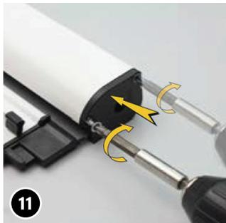
Das Lager ② muss den Rollokasten auf allen Seiten abdichten. Mit Hilfe von zwei Schrauben 4x16 anschrauben.
