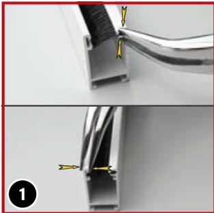
Zwicken Sie die Enden der Führungsschienen (Bürstenkanäle) mit einer Zange zusammen. Dies verhindert das Herausrutschen der Bürsten.
