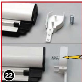
Stecken Sie nun die Endkappen (10) auf die Seiten eines Rollokastens auf. Bei einer der Endkappen befindet sich in der Mitte ein Steg. Hier wird vorher die Klemmfeder (31) über den Steg „gesteckt“ (sitzt ganz lose auf). Erst dann wird diese Endkappe am Kasten angebracht.
