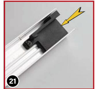
Schieben Sie je einen Führungsstopper (22) mit der Seite der eingedrehten Madenschraube (7) zuerst von jeder Seite des U-Profils aus ein.
