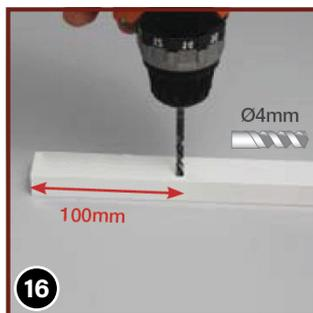
Auf der anderen Seite des U-Profils bohren Sie ebenso ein Loch Ø4 mm im 10 cm Abstand zum Ende des Profils hin leicht außermittig (nicht die Nut anbohren!).
