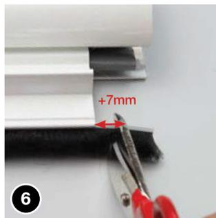
Die Bürstenstücke stehen nun etwas über die Griffschiene hinaus. Schneiden Sie diese soweit ab, dass die Bürstenstücke rechts und links jeweils 7 mm überstehen.
