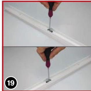
Die Haken für das U-Profil (21) nur ganz minimal anschrauben, da diese zum Schluss noch exakt ausgerichtet werden müssen. Die schmalen Haken der Griffschiene (20) müssen später in die breiten Haken des U-Profils (21) eingehängt werden können.
