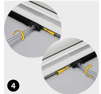
Schieben Sie anschließend die beiden schmalen Haken für die Griffschiene (20) rechts und links neben das lange Bürstenstück in die Griffschiene ein und befestigen Sie diese mit je einer Schraube 4x12 (23).
