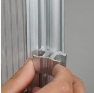
Die Schraubverbinder (18) auf die seitlichen Profilrohre klemmen.
