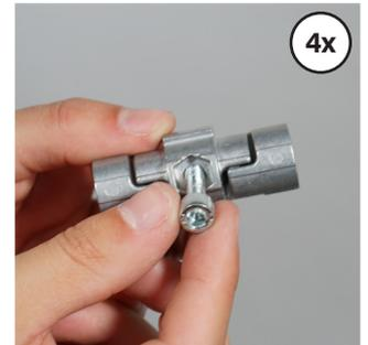
Den Steckverbinder (1) auf die gleiche Weise zusammenfügen und mit jeweils einer beiliegenden Sechskantmutter und einer Schraube fixieren.
