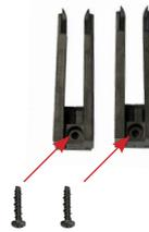
(b) Insérez les bases dans les rails de guidage par le bas
