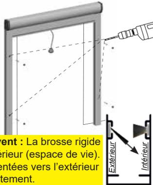
**Attention pour les brosses anti-vent :** La brosse rigide inclinée doit être orientée vers l'intérieur (espace de vie). Si les pointes des brosses sont orientées vers l'extérieur (côté ciel), repositionnez-les correctement.
