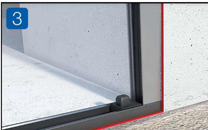
Befestigen Sie das Profil auf der Seite des Gewebepakets mit den Schrauben. Achten Sie darauf, dass der Schraubenkopf nicht über den Rand des Magneten hinausragt.
