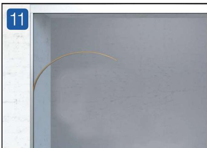
Drücken Sie das Abschluss-Magnetprofil in das dem Gewebepaket gegenüberliegende Profil ein.
