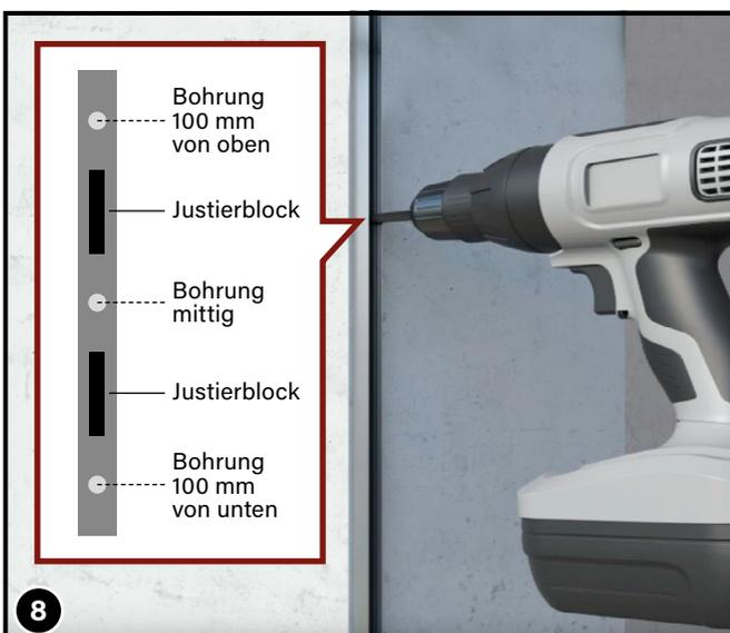
**ACHTUNG** Nicht durch die sogenannten Justierblöcke (schwarze Kunststoffteile) und Schnüre im Anschlagprofil (4) bohren! Falls sich hierin bereits ein Magnet befindet, diesen entfernen - es darf nicht durch den Magneten gebohrt werden!
