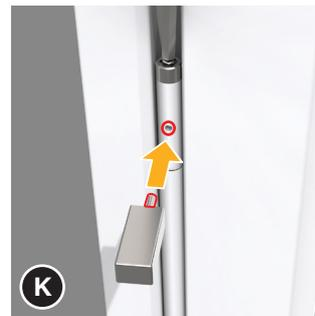
**K** Den Sicherungsbolzen in die Öffnung des Scharnieroberteils einsetzen. Dann die Funktion des Türschließers testen.
