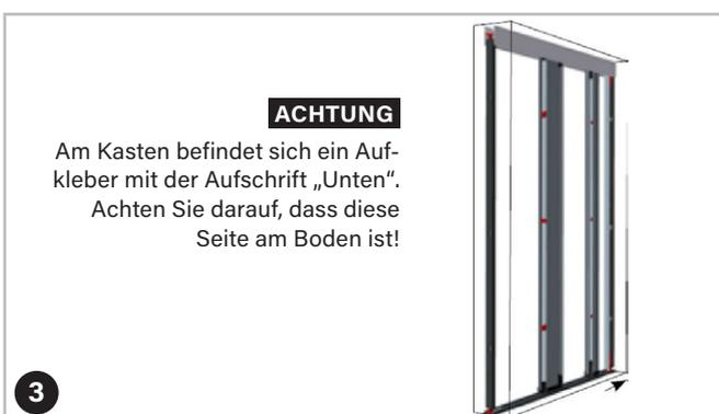
**Anschlagprofil ⑤a und Plisseekasten ⑤b zwischen Führungs- und Bodenschiene stellen**
