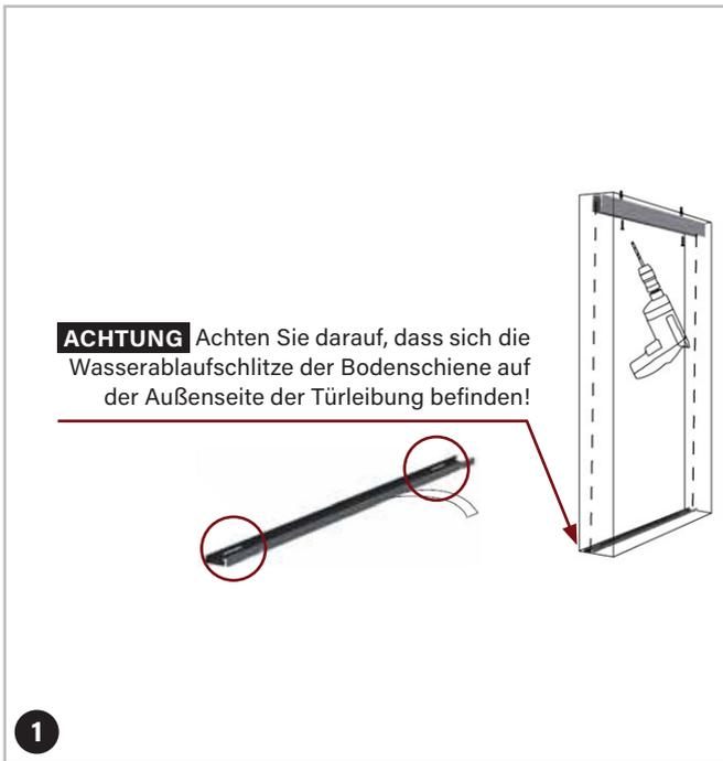
**Führungsschiene ① und Bodenschiene ② montieren**
