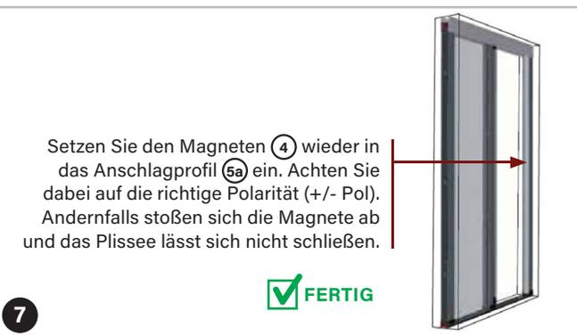
Setzen Sie den Magneten (4) wieder in das Anschlagprofil (5a) ein. Achten Sie dabei auf die richtige Polarität (+/- Pol). Andernfalls stoßen sich die Magnete ab und das Plissee lässt sich nicht schließen.
