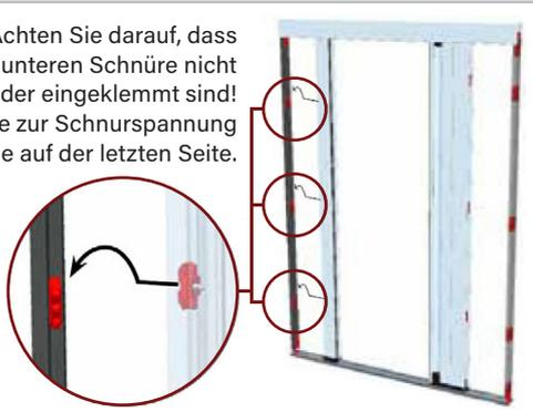
**Anschlagprofil (5a) in einem der beiden Wandprofile (3) einhängen**
