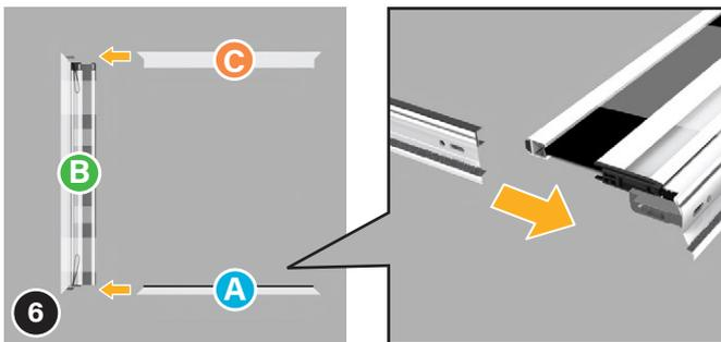
Insérez les sections (A), (B) et (C) ensemble pour former trois côtés du cadre.
