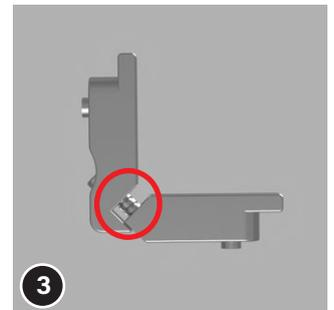
Serrez les vis des équerres (3) à l'aide de la clé hexagonale de 3,0 mm (15). Assurez-vous que les deux moitiés de l'équerre sont correctement alignées.
