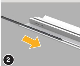
Glissez la brosse (19) dans les rainures des profils de cadre de montage (1) et (2) dans les sections (A), (B), (C) et (D). Ensuite, coupez la brosse en excès avec une paire de ciseaux ou un cutter.
