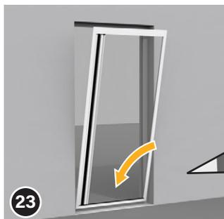
Posez le cadre de montage sur le feuillure de la fenêtre ou de la porte. Faites glisser les plaques d'angle inférieures complètement vers l'extérieur, audessus du joint d'étanchéité.
