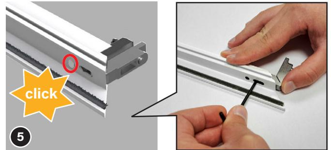
Les tiges des équerres doivent s'enclencher dans les trous ronds des profils de cadre (2).
