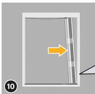
Retirez le film d'emballage autour du cadre et du boîtier plissé. Faites glisser le boîtier plissé dans l'un des côtés du cadre.
