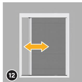
Retirez maintenant le film d'emballage du paquet plissé. Testez le fonctionnement du plissé en déplaçant le rail de poignée.
