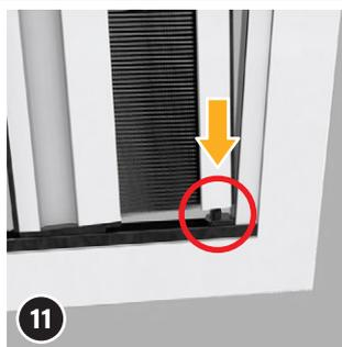
Insérez le profil d'arrêt dans l'embout inférieur (10). L'aimant à l'arrière du boîtier plissé s'enclenche alors dans l'aimant du rail de fixation (7).
