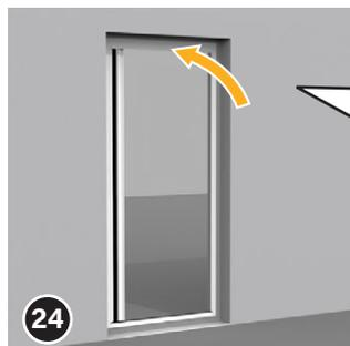
Poussez le plissé en haut contre le cadre. Faites glisser les plaques d'angle supérieures vers l'extérieur, au-dessus du joint d'étanchéité. Serrez toutes les vis des plaques d'angle pour sécuriser le cadre en place.
