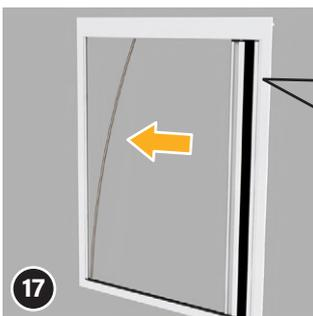
Retirez l'aimant (22) du rail de poignée et clipsez-le dans le profil de fixation.
