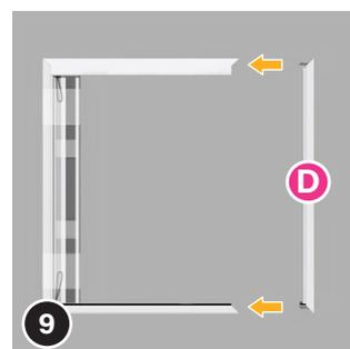
Fixez la dernière section (D) et serrez également les vis des équerres. Nettoyez les profils avec un chiffon doux et de l'alcool à brûler avant de poursuivre l'installation.
