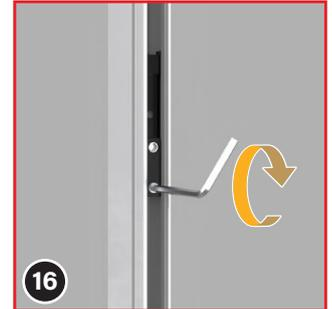
Serrez ensuite les vis des blocs de tension pour les fixer à nouveau.
