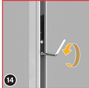
Tournez légèrement les vis des blocs de tension avec la clé hexagonale de 2,0 mm fournie (14) pour les desserrer.
