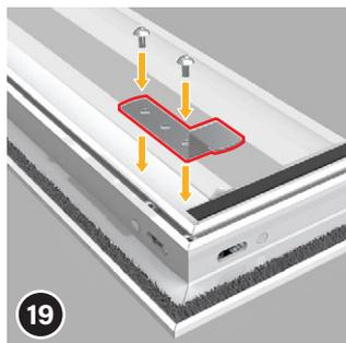
Vissez les plaques d'angle (27) en haut et en bas à l'aide des vis cylindriques M3 x 5 (29) et de la clé hexagonale de 2,0 mm (14). Référez-vous à l'image ci-contre pour trouver la position correcte. Ne serrez pas complètement les vis pour permettre un ajustement des plaques d'angle si nécessaire.
