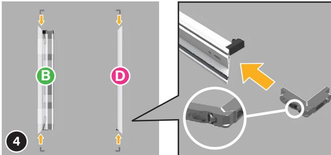
Insérez les équerres (3) dans les extrémités des profils latéraux (B) & (D).
