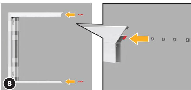
Placez quatre écrous carrés (28) dans les rails des profils supérieur et inférieur du cadre de montage.
