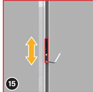
Déplacez les blocs de tension légèrement vers le haut ou vers le bas pour ajuster la tension des cordes. Les cordes doivent être légèrement tendues et le plissé doit se fermer facilement et de manière droite.
