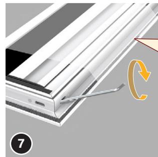
Serrez les vis des équerres (3) avec la clé hexagonale de 3,0 mm jusqu'à ce que les profils soient parfaitement alignés et maintenus ensemble.
