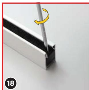
Après avoir inséré les socles (5) dans les rails, vissez-les légèrement avec 2 à 3 tours, afin de permettre des ajustements en hauteur jusqu'à la fin de l'installation.
