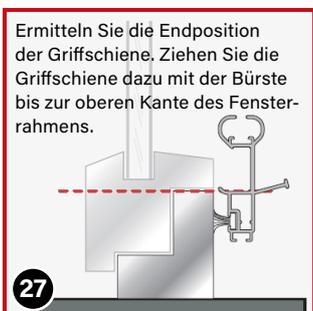
Ermitteln Sie die Endposition der Griffschiene. Ziehen Sie die Griffschiene dazu mit der Bürste bis zur oberen Kante des Fensterrahmens.
