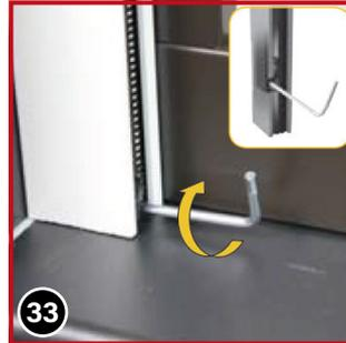
Richten Sie die Sockel **5** auf gleicher Höhe aus und befestigen Sie diese, indem Sie die Madenschrauben mehrmals mit dem Sechskantschlüssel **50** festdrehen. Danach testen Sie den Verschluss und passen ggf. die Position der Sockel an.
