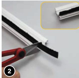
Die Bürste auf die exakte Größe der Griffschiene zuschneiden. Dazu die Bürste auf einer Seite der Griffschiene am Ende anhalten und auf der anderen Seite ablängen.
